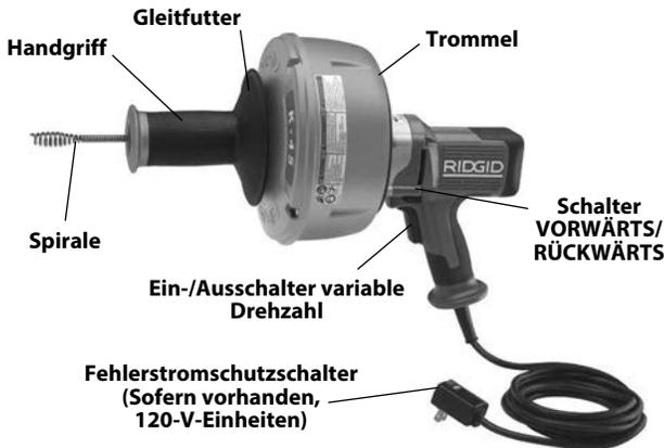
**Abbildung 1 – K-45 Rohrreinigungsmaschine mit Spannfutter.**
