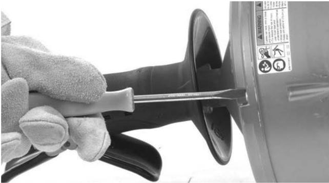
**Abbildung 13 – 4 Trommelschrauben etwa 3 Umdrehungen lösen, aber nicht entfernen**
