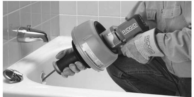
**Abbildung 9 – Spirale in den Abfluss schieben**
