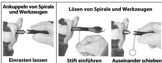
Abbildung 7 – Anschließen und Lösen von Werkzeugen
