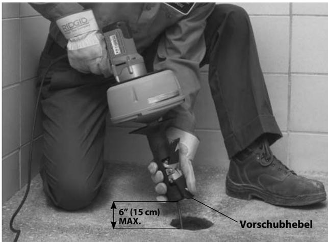
**Abbildung 10 – Vorwärtsschieben der Spirale mit AUTOFEED**
