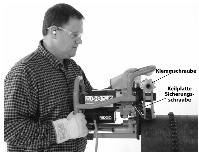
Abbildung 15A – Platzieren des Anfasgeräts am Rohr
