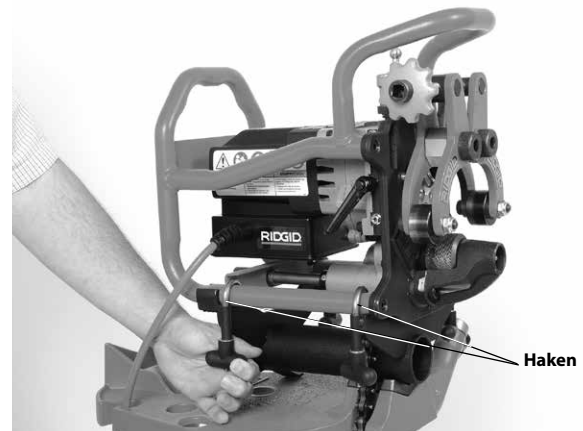
Abbildung 9 – Sichern des Anfasgerätes am Adapter
