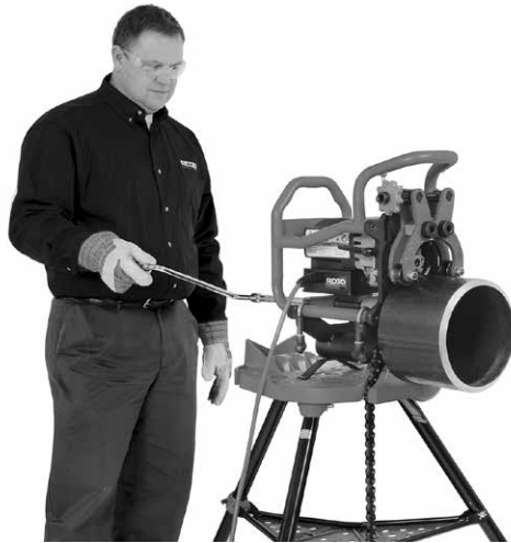
Abbildung 20C – Anfasen (fixiertes Anfasgerät/rotieren-des Rohr)
