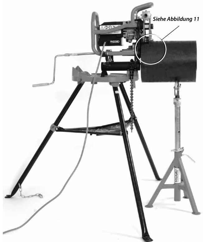
Abbildung 12 – Fixiertes Anfasgerät, kurzes Rohr, ein Rohrstände
