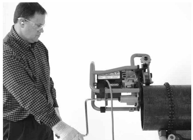
Abbildung 20A – Anfasen (fixiertes Werkstück/bewegtes Anfasgerät)
