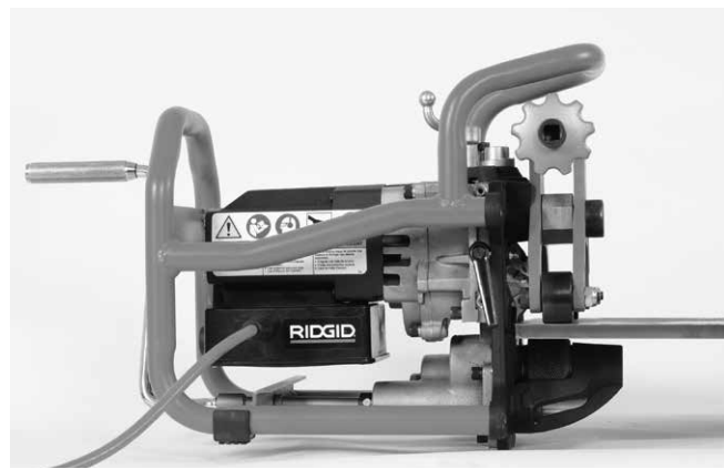
Abbildung 16B – Anbringen des Anfasgeräts an einer Platte
