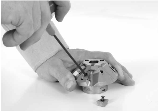
Abbildung 24 – Wechseln der Schneideinsätze
