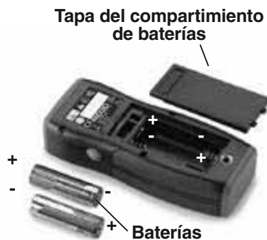
Figura 5 – Reemplazo de las baterías
