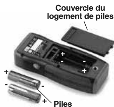
Figure 5 – Remplacement des piles
