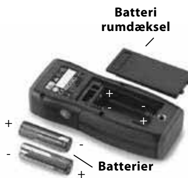
Figur 5 – Udskiftning af batterier
