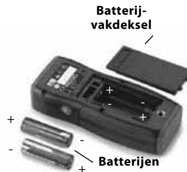
Figuur 5 – Batterijen vervangen
