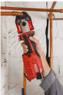
Öffnen der Pressbacke und Betätigung des Auslösers mit derselben Hand, spart Zeit und Mühe!
