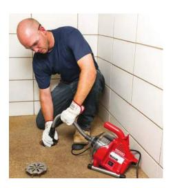
Die leistungsstarke, kompakte und vielseitige PowerClear™ Rohrreinigungsmaschine reinigt spielend Badewannen, Dusch- und Beckenabläufe bis 40 mm Durchmesser (max. 50 mm bei leichten Blockaden).
