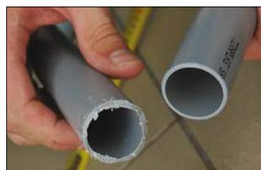
Mit einer Bügelsäge geschnitten (links), und mit dem P-TEC 3240 (rechts).
