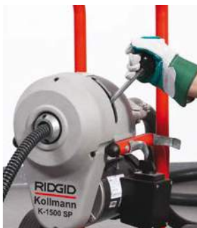
Wenn die Kupplung greift, rotiert die Spirale
