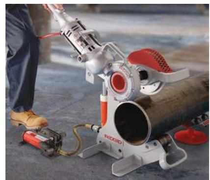
Elektro-Rohrabschneider Modell 258 mit Kraftantrieb Modell 700 beim Schneiden
